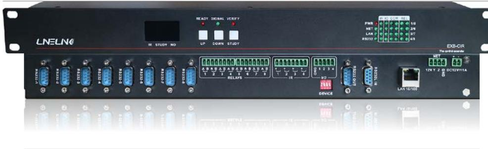
EXB-CIR 中控综合扩展器是采用高精度集成电路和工业级芯片集成的一款具有 232 串口扩展，LAN 网口、232、485 输入输出控制，IO 控制，继电器控制及红外学习和发送的中控扩展多用途设备。EXB-CIR 拥有 8 路独立双向 RS232 接口，4 路独立的 IO 输入输出接口，8 路继电器控制，简便的红外学习功能面板和 4 路红外输出接口，可为用户的不同使用需求提供帮助。
