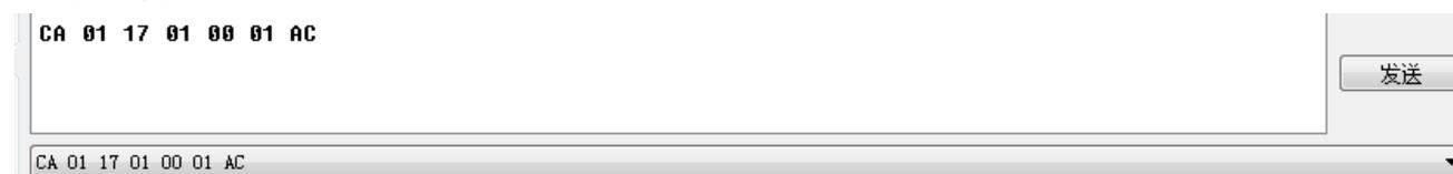
表示设备 1 第一个输入输出端口配置为输出，输出高电平。
