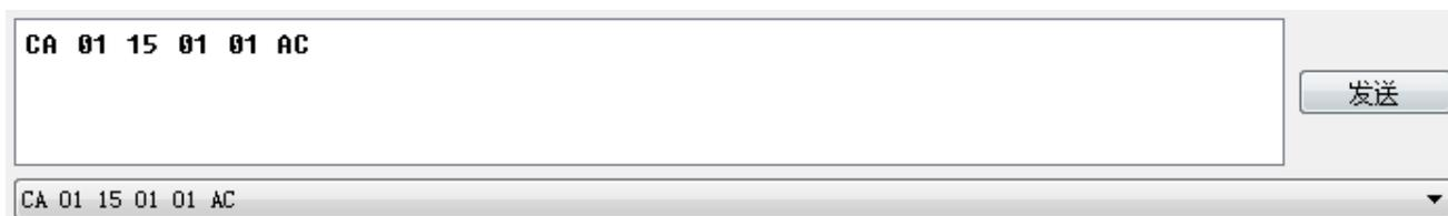
例如 **CA 01 15 01 01 AC** 即为打开 1 号设备的 1 号继电器，**CA 03 15 02 00 AC** 即为关闭 3 号设备的 2 号继电器。
