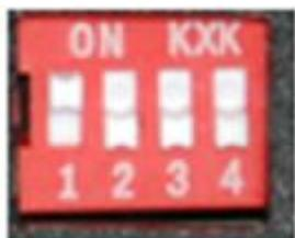
当 PS-LINK8 级联使用时，为区分不同的设备，需要设置设备地址。设备后面板 4 位拨码开关用于设定设备地址，四位拨码开关从左到右拨上去以后分别对应于数值 1、2、4、8，设备地址的计算方式为所有拨上去的位置的数值之和，例如 1，3 位拨上去，2，4 位未拨上去，则设备地址计算为  $1 + 4 = 5$ 。设备地址更改以后，设备需要重启以应用新的地址，重新上电以前仍为更改之前的设备地址有效。控制指令中的地址码为 00 时控制指令为广播指令，对于
