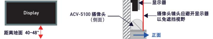
FIG. 4 ACV-5100 壁挂式安装注意事项
