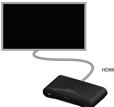
图像 4-2: 显示装置连接
