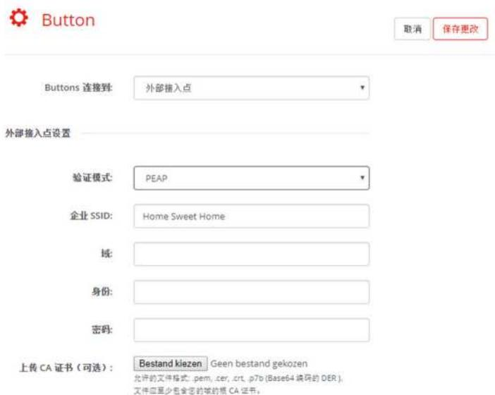
图像 6-47: Button、外部接入点、PEAP 模式
