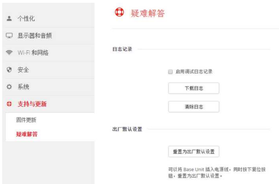
图像 6-52: 故障排除，出厂设置
